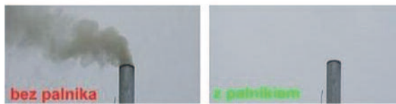
Różnica w emisyjności kotłów domowych przed i po modernizacji jest ogromna. Użycie palnika Eko-Wery zmniejsza m.in. emisję tlenku węgla z 8 565 do 114 ppm.
